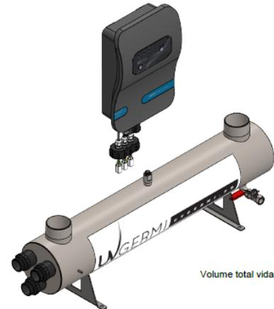
Dans la chambre de traitement, les lampes UV sont placées dans des gaines en quartz. Cette réalisation permet d'éviter le refroidissement des lampes par le passage de l'eau, car leur efficacité maximale est à 40°C. La couche d'air entre les gaines et les lampes suffit pour maintenir cette température : les gaines de quartz servent de séparation entre les lampes et le liquide comme isolation électrique et thermique.
